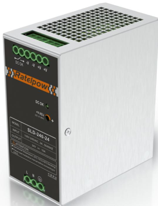
Однофазный промышленный блок питания с креплением на дин-рейку. Выходное напряжение 24В постоянного тока, мощность 240Вт. Диапазон регулировки выходного напряжения 22.8-28В. Функционал STR позволяет получить кратковременный запас по мощности 150% от номинального значения в течение 3х секунд. Корпус выполнен из оцинкованного металла со шлифованными гранями, что исключает возможность каррозии при использовании изделия в условиях повышенной влажности.
